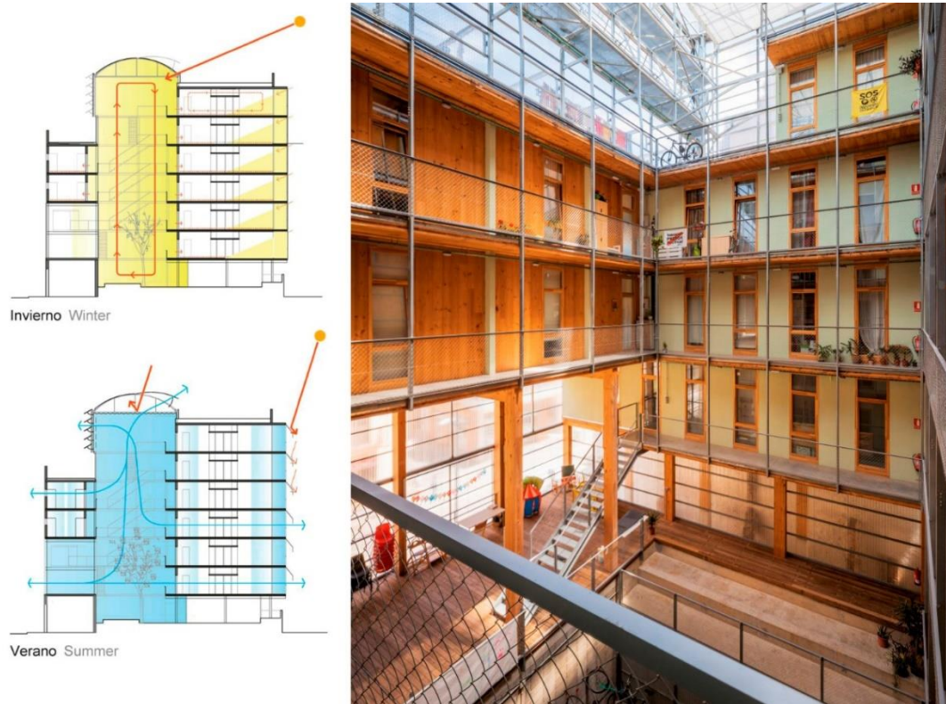
Fig. 14 Izq. Importancia del patio interior para el esquema de ventilación y soleamiento del edificio en verano e invierno. Dcha. Vista del patio interior.
