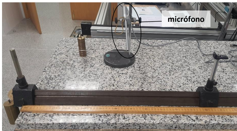
Figura 5. Montaje experimental visto de frente: cuerda anclada en el extremo derecho y con las pesas colgadas en el izquierdo. Micrófono en el centro.
