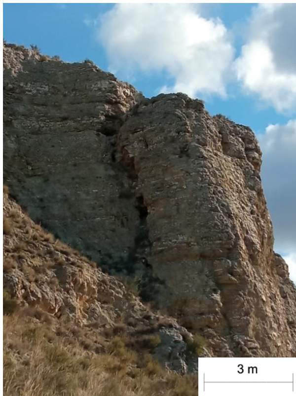
Fig. 6 Grieta subvertical susceptible de producir un vuelco por desplome.
