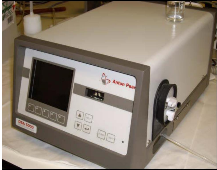
Figura 3.1 Analizador de densidad y velocidad de propagación del sonido Anton Paar DSA 5000M
