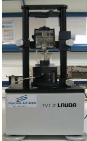
Figura 3.3: Tensiómetro de gota Lauda TVT-2
