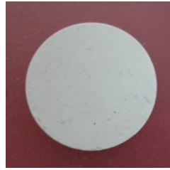
Fig. 52. Muestra de una pastilla de 13 mm de diámetro y 1 mm de espesor de zeolita
