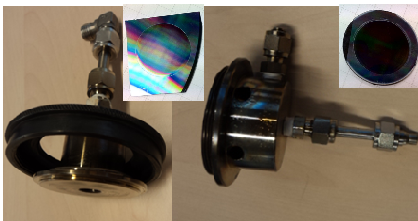
Fig. 292: Reactor para probar los micromonolitos en reacción de COVs
