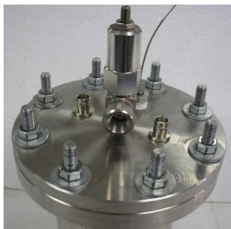
Fig. 50. Diseño y accesorios de la tapa de la autoclave
