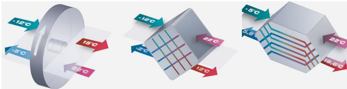
Figura 26. Principio de funcionamiento de los recuperadores rotativos (izquierda) y de placas a flujo cruzado (centro) y contracorriente (derecha). Fuente: Wolf
