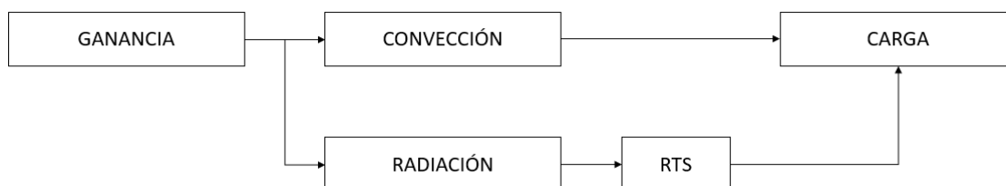
Figura 35. Método RTS: Transformación de ganancias. Elab. propia a partir de [38]
