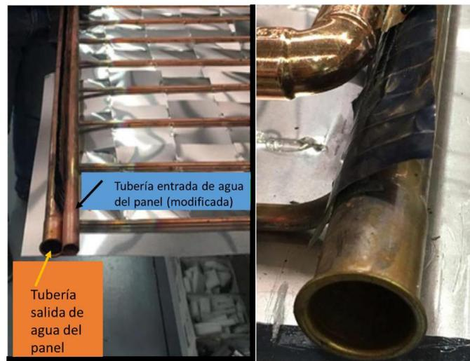
Figura 16: Modificación colector [31]
