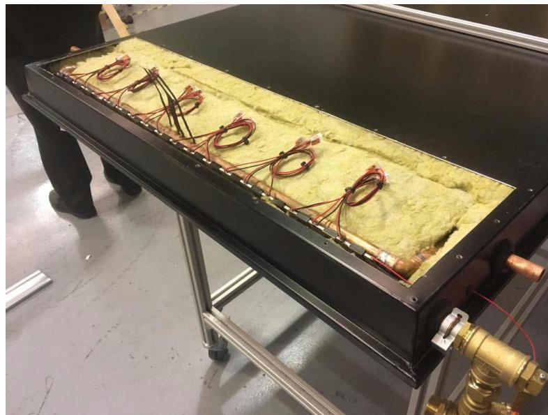
Figura 9: Detalle apertura para módulos TEG [1].
