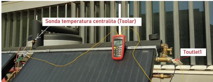
Figura 15: Detalle de la situación de las sondas [1].
