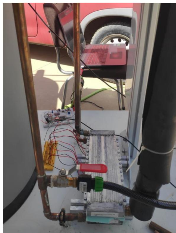
Figura 22: Detalle del radiador con la entrada de agua de red.
