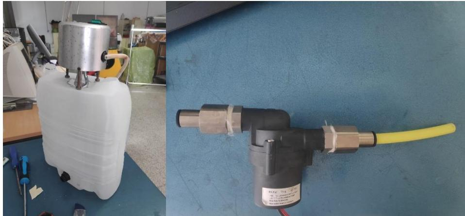
Figura 23: Depósito caliente junto con termo-resistencia y bomba hidráulica .
