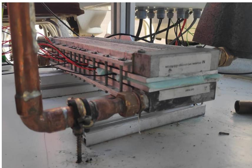
Figura 87: Detalle del aislamiento en el radiador.
