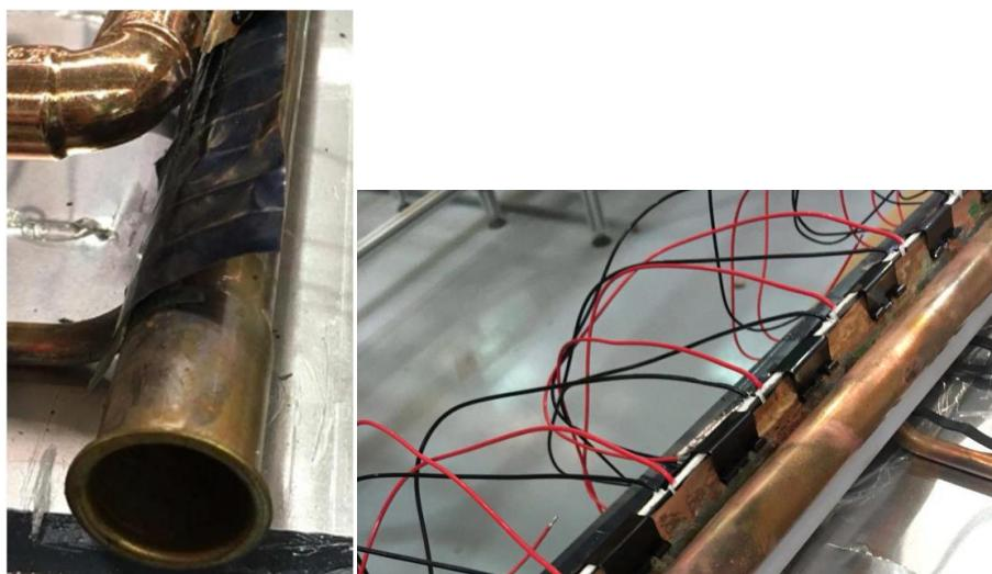
Figura 7: Detalle de la instalación de los módulos TEG [1].
