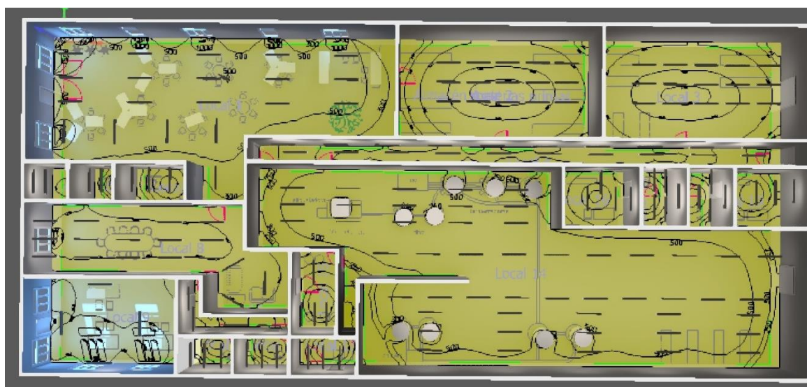
Figura 4. Disposición de la luminaria en la fábrica.
