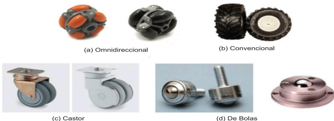
Figura 38. Tipos de ruedas en robots móviles
