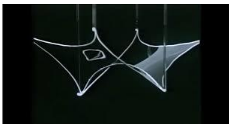
Fig. 12 Modelo de membranas de jabón estructuras de paraboloide hiperbólico.
