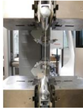
Fig. 56 Ensayo uniaxial de tracción Obtenido: Strain-rate dependent tensile strengths of PTFE-fabrics by using the Strip Method
