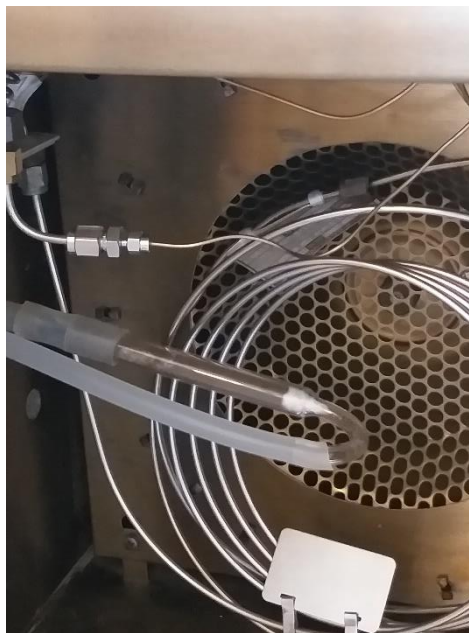
Figura 9. Tubo en U de vidrio con lecho fijo.
