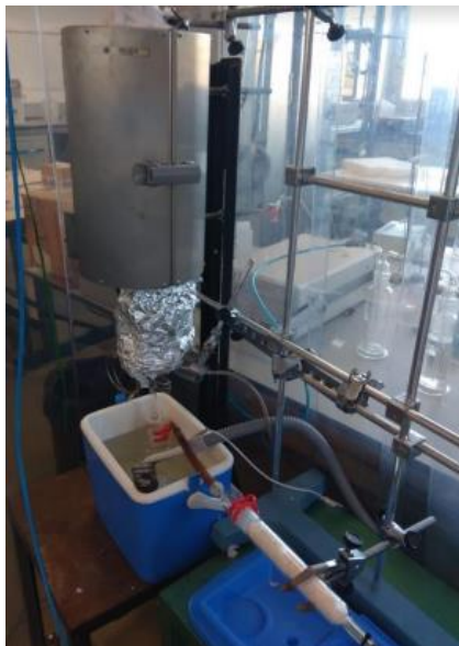
Figura 1. Planta de pirólisis en reactor de lecho fijo.
