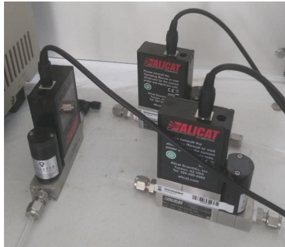
Figura 8. Controladores de caudal de \text{N}_2 , Ar y \text{CO}_2 .
