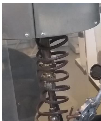
Figura 7. Resistencia en la zona inferior del horno.
