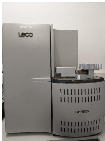
Figura 12. Analizador LECO TruSpec Micro.
