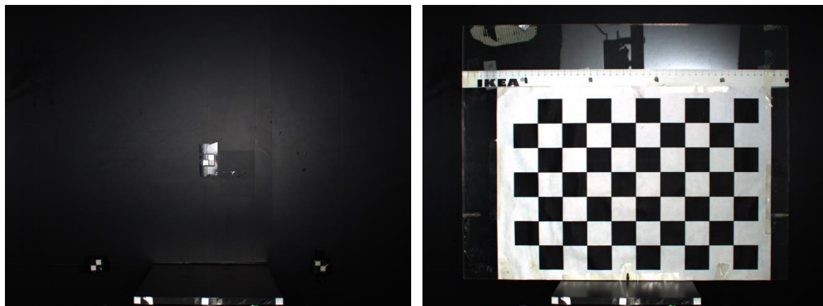
Figura 10: Imagen inicial de la calibración (izquierda) e imagen tras colocar cuadrícula (derecha)
