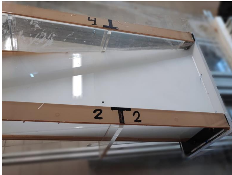
Figura 7: Canal auxiliar para calibración de la Kinect
