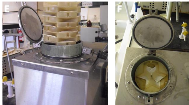
E y F: Introducción del suspensor con las bolsas de filtración en el analizador de fibra.
