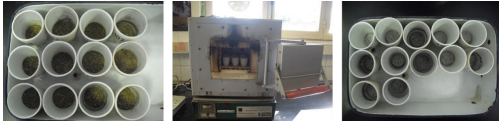
Figuras 46, 47 y 48: De izquierda a derecha: Muestras depositadas en crisoles de porcelana, crisoles introducidos en el horno de mufla y muestras totalmente calcinadas (cenizas).
