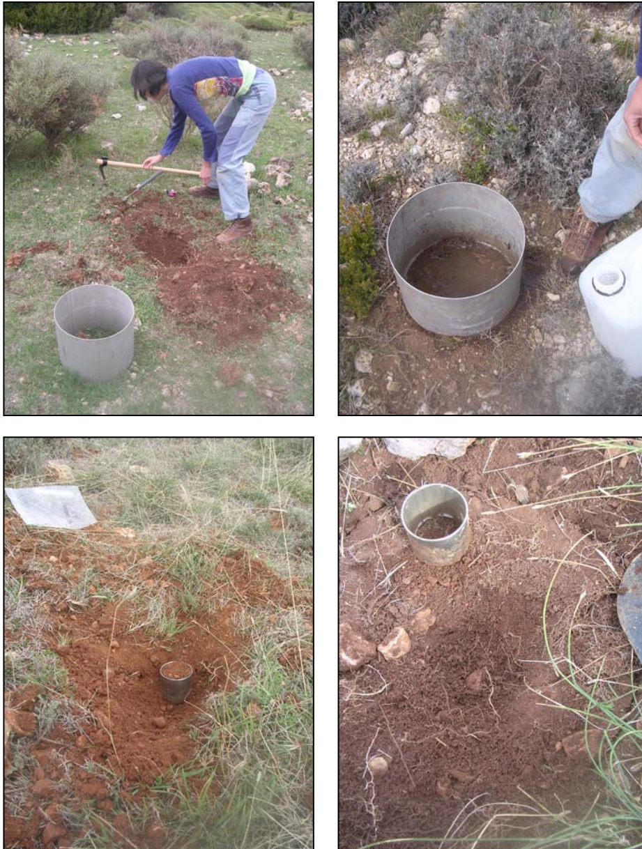
Figura 5.13: Ejemplo de algunos de los suelos seleccionados para obtener los parámetros de capacidad de campo y punto de marchitez.
