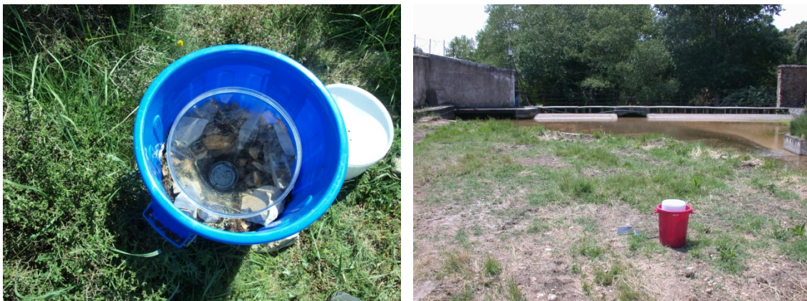
Figura 3.4: Detalle de los pluviocaptadores situados en el entorno de San Julián de Banzo (Huesca).
