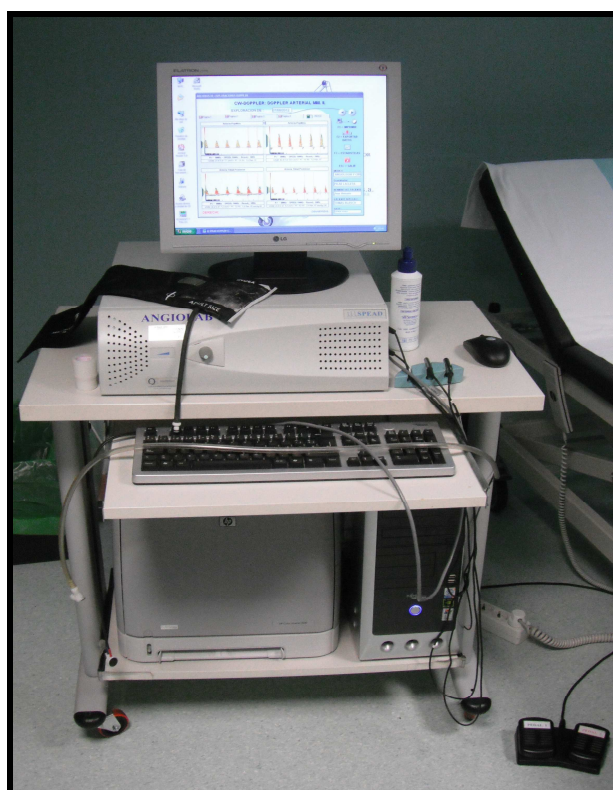
Figura 2: Equipo de pruebas funcionales (Angiolab I, Spead-Doppler-Systeme GmbH, Kehl, Alemania). Fuente: Servicio de Angiología y Cirugía Vascular. Hospital Universitario Miguel Servet. Zaragoza. España.
