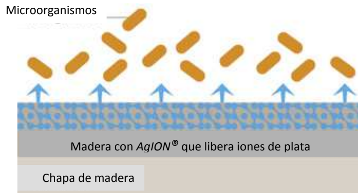
Figura 1.23. Mecanismo de liberación de iones plata en muebles [282]
