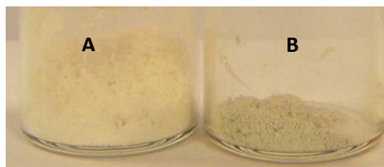
Figura 4.15. Fotografía óptica mostrando la zeolita ZSM5 en diferentes estados. A) Ag-ZSM5 donde la plata es iónica y no aporta color a la muestra y B) AgNPs-ZSM5 donde ya se han formado AgNPs y, por tanto, la muestra adquiere un color grisáceo
