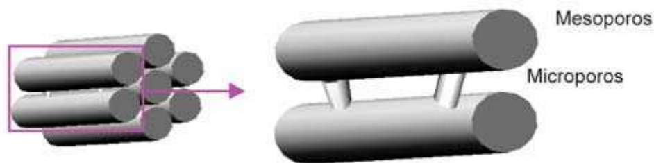
Figura 1.14. Esquema ilustrativo del sistema poroso en SBA-15 [166]
