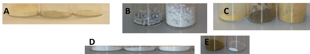
Figura 6.1. Blanqueamiento de los materiales al adsorberse PAA. A) Ag-ZSM5, AgNPs-ZSM5 y AgNPs-ZSM5-PAA. B) Zeolita comercial en forma de pellets y Zeolita comercial en forma de pellets con PAA. C) MCM 41-MagNPs, MCM41-MagNPs-AgNPs y MCM41-MagNPs-AgNPs-PAA. D) SBA 15-APTES, SBA 15-APTES-Ag-B y SBA 15-APTES-Ag-B-PAA. E) SBA 15-APTES-Ag-A y SBA 15-APTES-Ag-A-PAA
