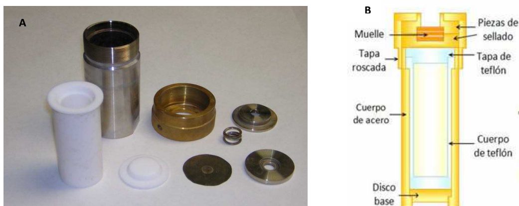
Figura 2.4. A) Componentes de la autoclave. B) Esquema de la autoclave
