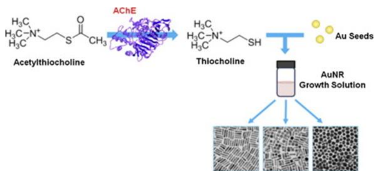
Figura 8.5: Crecimiento de AuNRs mediado por semillas de Au y AChE
