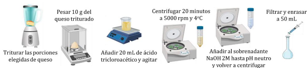
Figura 4.8: Esquema del tratamiento del queso Emmental para la extracción de aminas biógenas.
