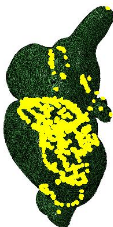
Figura 4.5. En amarillo sobre el mallado del modelo, los elementos que tienen un factor de forma malo o que son relativamente pequeños o irregulares. Se localizan en las uniones e intersecciones de las regiones anatómicas (Dassault Systèmes Simulia Corp, 2014).
