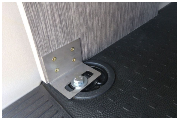
Figura 131. Anclaje kit cama básico Vantrip
