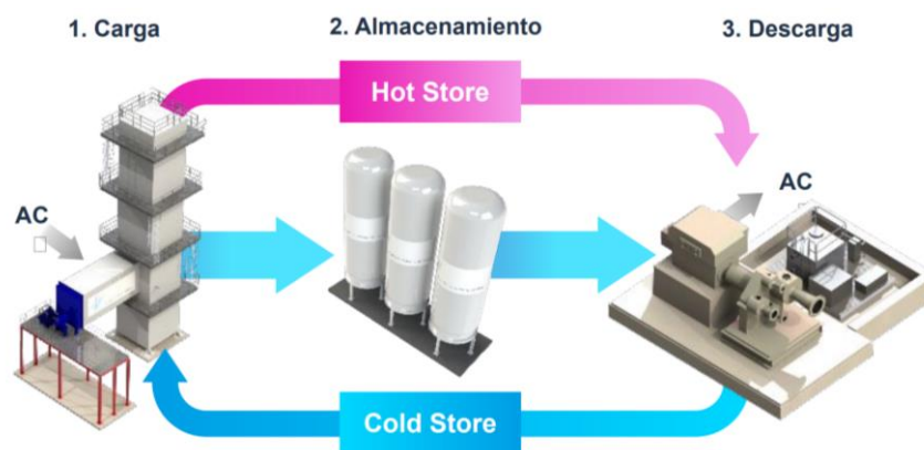
Figura 9: Esquema simple de la tecnología CryoBattery (HighviewPower, 2021)
