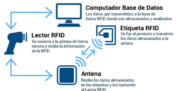
Figura 135. Sistema RFID Fuente: Propia
