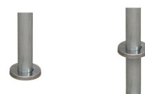
Figura 142. Diferencias entre empotrado y anclado Fuente: cervienvironment.com
