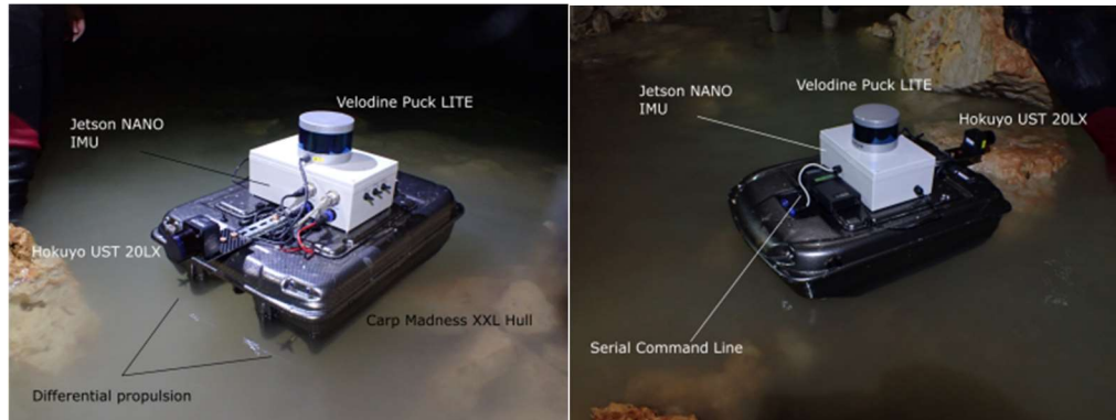
FIG. 1 VISTAS TRASERA Y FRONTAL DEL BARCO USV ROBOBOAT Y SUS PARTES
