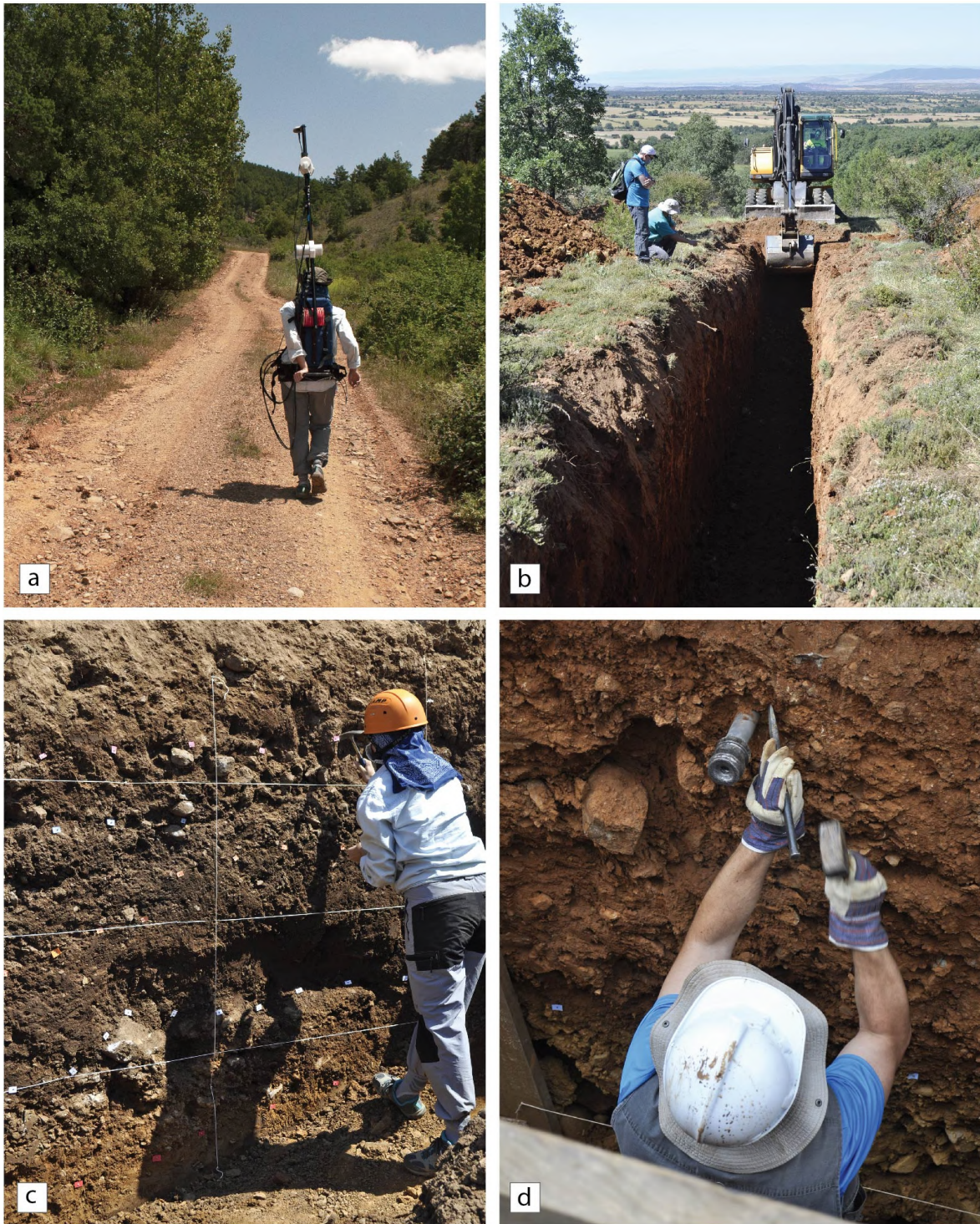
Fig. 1.6.- (a) Prospección con magnetómetro de efecto Overhauser. (b) Excavación de la trinchera. (c) Estudio de los taludes de la trinchera. (d) Toma de muestras para datación por OSL. Todas ellas con relación a la trinchera de Lagueruela.
