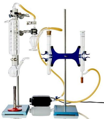
Ilustración VI. Imagen esquemática del montaje para llevar a cabo el método Rankine.
