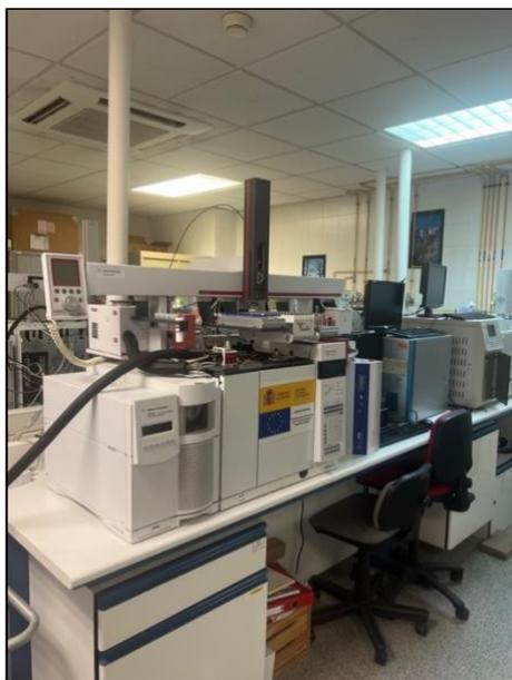
*Figura 5. Cromatógrafo de Gases acoplado a Espectrómetro de Masas (MD-GC-MS)*
