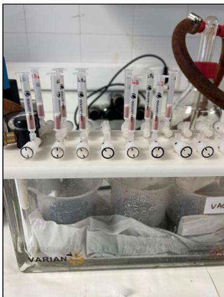
*Figura 4: Sistema de Vacío para la SBE, modelo Vac Elut 20*
