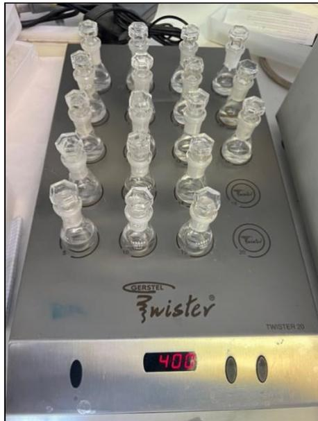
Figura 2: Barras Twister agitándose a 400 rpm
