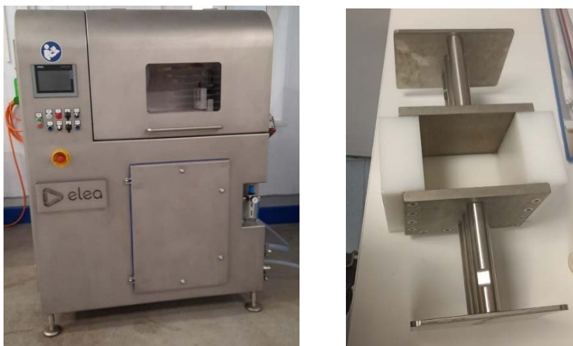
Figura 5.2.3. Imagen del equipo PEF Pilot™ Dual (izquierda) y cámara de tratamiento (derecha).
