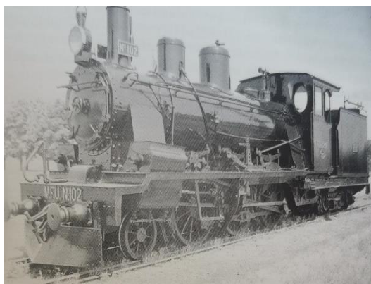
Ilustración 10.-Locomotora nº102 "GUILLERMA". Dotada de 2 cilindros en alta presión y con un peso total en servicio de 60 Tm.
