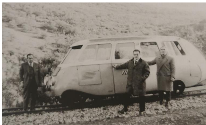
Ilustración 14.-Autovía nº1 utilizada en el ferrocarril para la inspección de la línea y otros servicios especiales.
