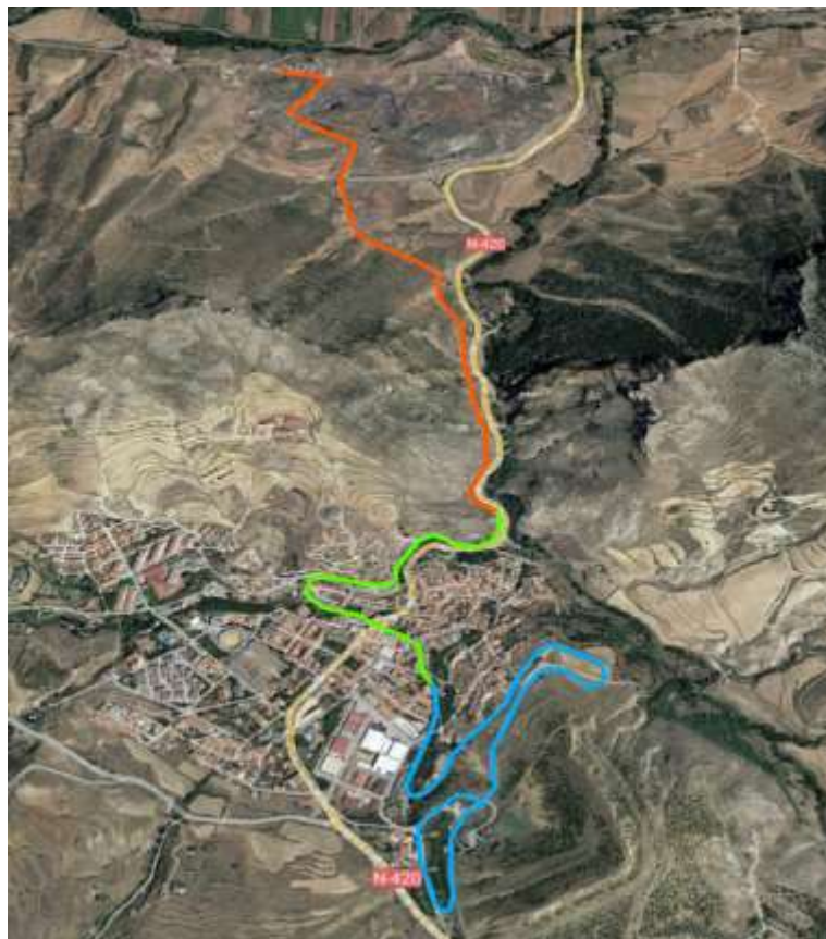
Ilustración 2.-En azul el tramo actual, en rojo el tramo de Utrillas a Lavaderos, en verde la Alternativa B
