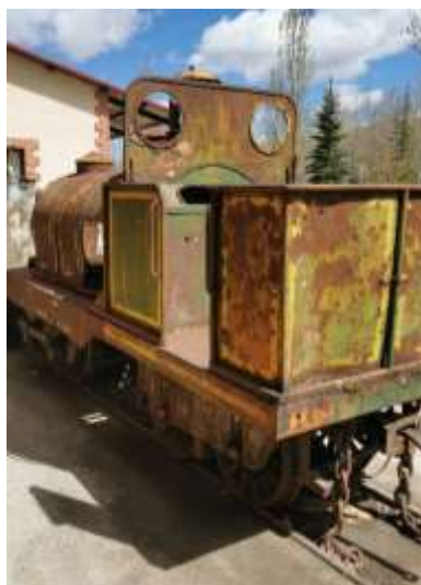
Ilustración 13.-Situación de la locomotora nº1 previa rehabilitación.
