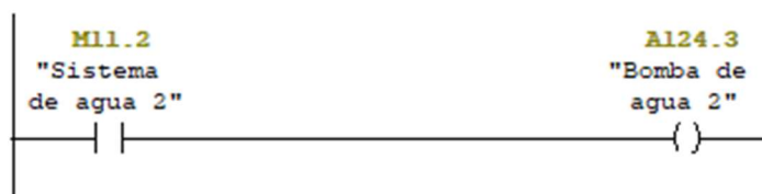
Ilustración 60: Programación FC1 Bomba bebederos.
