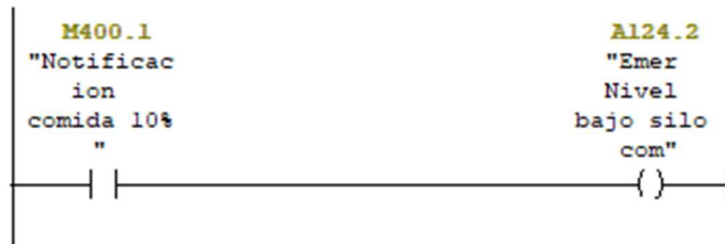
Ilustración 67: Programación FC4 emergencia nivel bajo de silo.
