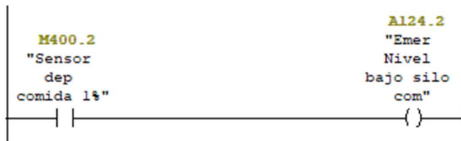
Ilustración 62: Programación FC2 emergencia nivel bajo de silo.
