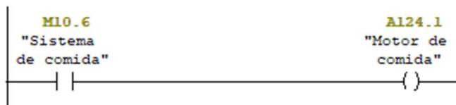
Ilustración 61: Programación FC2 motor comida silo.
