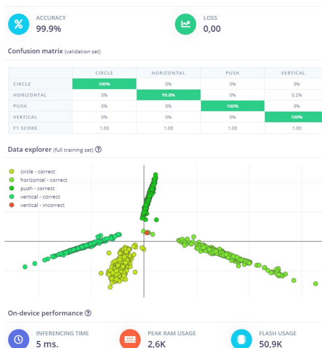
Figura 28. Resultados del modelo con 60 neuronas y análisis espectral previo
