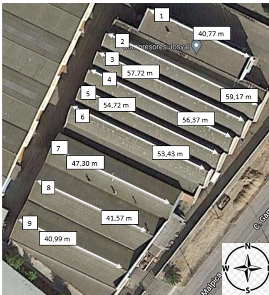
Figura 19 Representación de las dimensiones de las diferentes superficies del tenado de la nave industrial. Realización a partir de la Fuente: [27]
