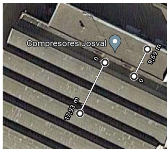
Figura 32 Medidas de los strings hasta los inversores. Fuente: [27]
