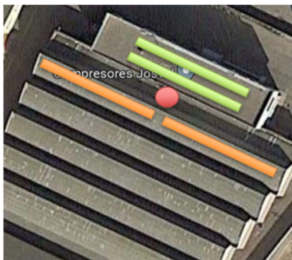
Figura 30 Disposición de las placas sobre la superficie del tejado. Realizado a partir de la Fuente: [27]
