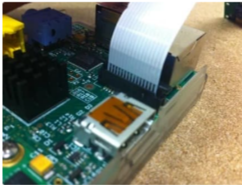
Figure 15: Módulo de la cámara montado en el puerto de la Raspberry Pi[2]
