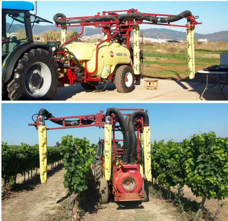
Figura 2. Pulverizador hidroneumático estudiado en este trabajo. Modelo IRIS (ILEMO HARDI S.A.U., Lleida, España). Arriba: vista general. Abajo: vista trasera, con sólo una pareja de bajantes desplegada.
