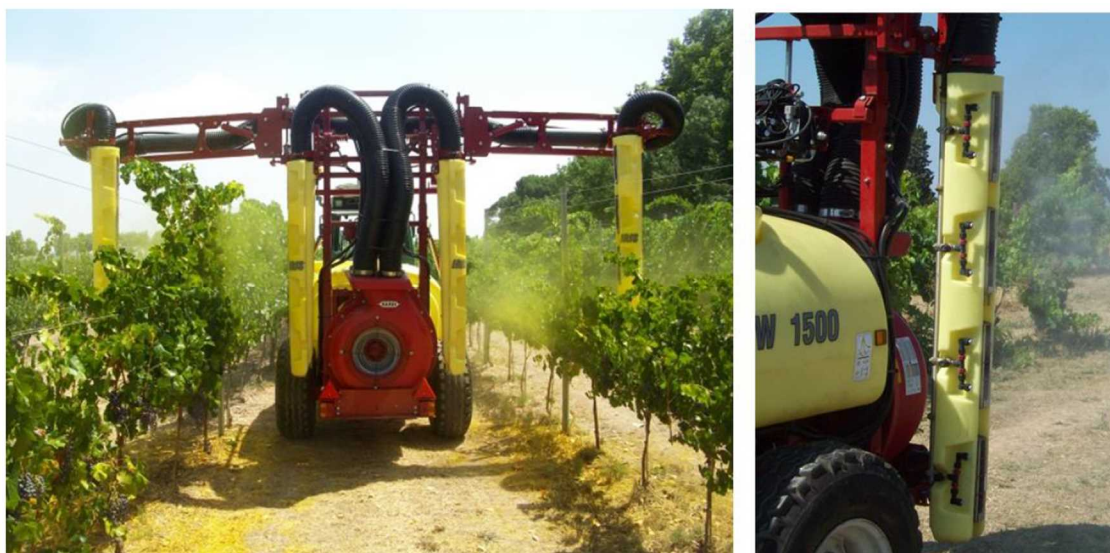
Figura 28. Pulverizador con conductos verticales para cultivos en espaldera analizado en este trabajo. Izquierda: demostración de funcionamiento. Derecha: detalle de uno de los bajantes, en los que se pueden ver las 4 zonas de salida de aire (toberas) y las boquillas de pulverización hidráulica, 2 por tobera, en total 8 por bajante.
