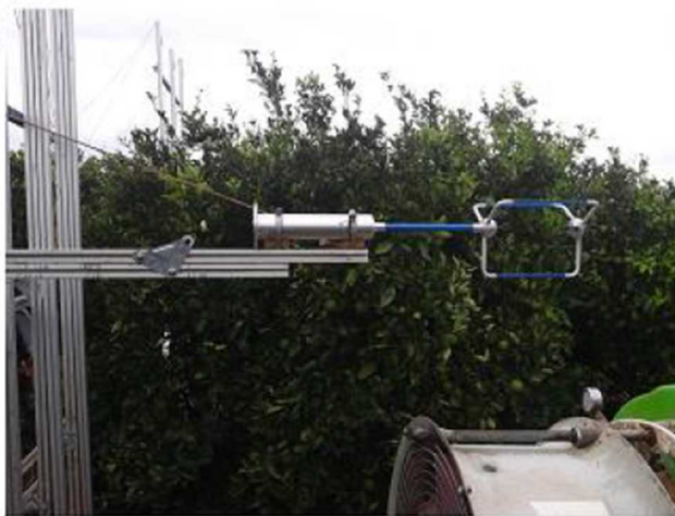
Figura 27. Ensayo de un pulverizador hidroneumático. Arriba, izquierda: pulverizador estudiado. Abajo, izquierda: anemómetro de tres dimensiones usado para medir las corrientes de aire a cierta distancia del ventilador. Arriba, derecha: discretización de las zonas de medición de las corrientes de aire. Abajo, derecha: conversión de lo anterior en condición de contorno para el modelo CFD. (Fuente: Salcedo, 2015).
