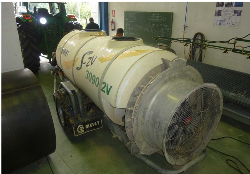
Figura 3. Pulverizador hidroneumático en un laboratorio de maquinaria para proceder a estudiar su sistema de agitación. Modelo Melet 30902V (Garmelet, Zaidín, España).
