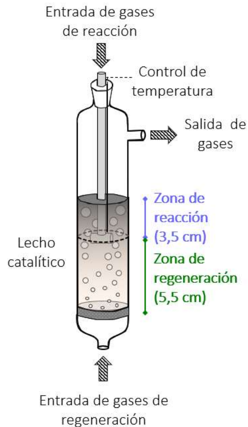
Figura 10. Esquema de reactor en configuración de lecho fluidizado de dos zonas.
