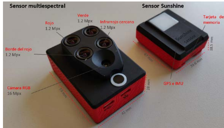
Figura III-7. Cámara Sequoia y sensor Sunshine (información obtenida de Parrot Sequoia, 2017).
