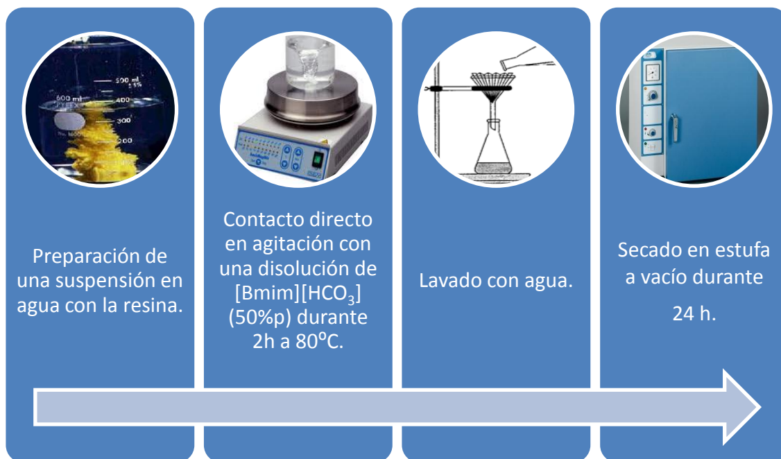
Figura 7: Proceso de síntesis en discontinuo con [Bmim][HCO 3 ]
