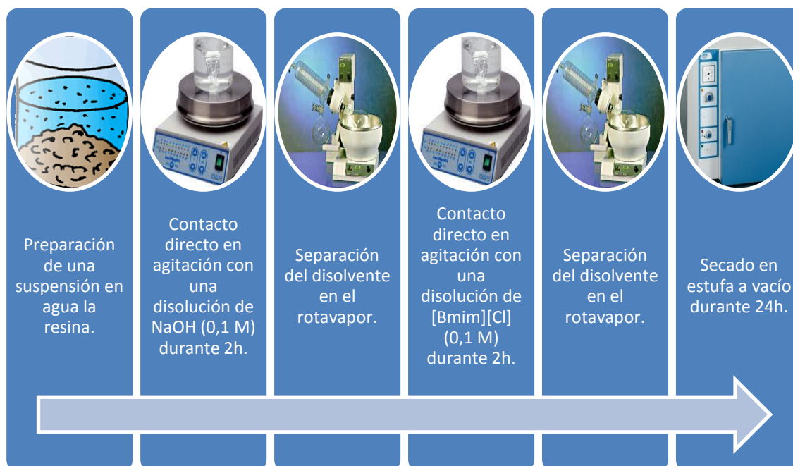
Figura 6: Proceso de síntesis en discontinuo de PSCLI
