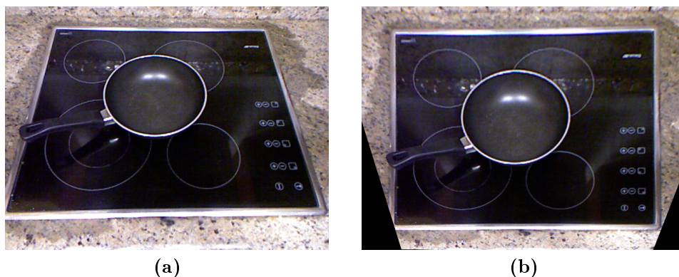
Figura 2.6: (a) Visión de la placa antes de aplicar la matriz homográfica (b) Visión de la placa transformada con la matriz homográfica
