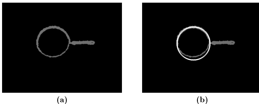
Figura 2.12: (a) Forma del recipiente después del filtro de Gauss (b) Forma del recipiente con el contorno hallado
