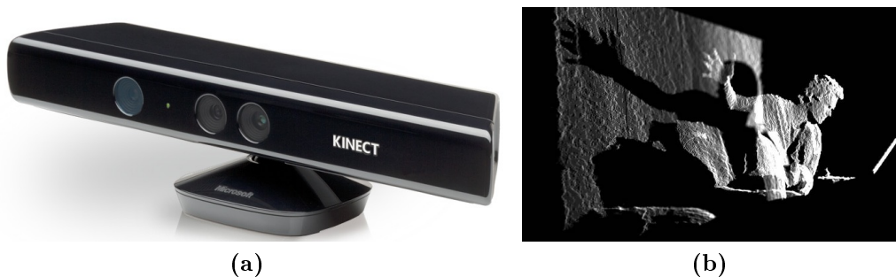
Figura 1.2: Microsoft Kinect (a) y un ejemplo de imagen tridimensional captada por ella (b)
