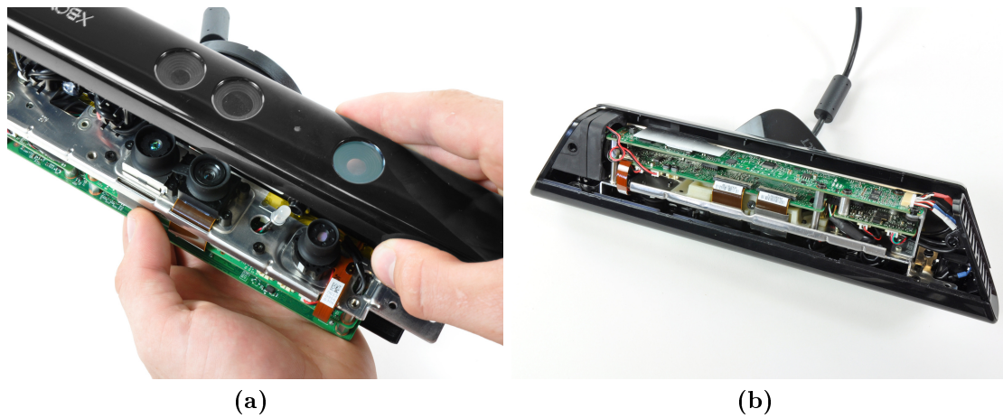
Figura A.6: a) Sensores y láser empotrados en una placa metálica. b) Placas paralelas a la metálica con la electrónica y microchips que controlan el dispositivo.
