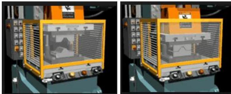
Fig 3.34 Imagen izda: posición prensa abierta. Imagen dcha: posición prensa cerrada
