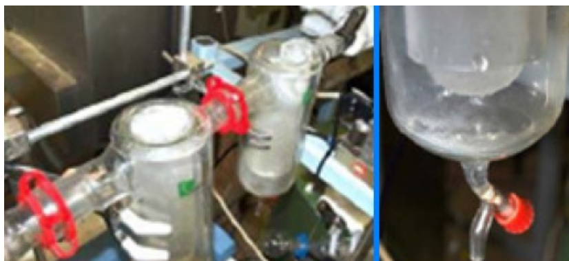
Figura B.6. Sistema de condensación (Izda.) y detalle del condensador (Dcha.).
