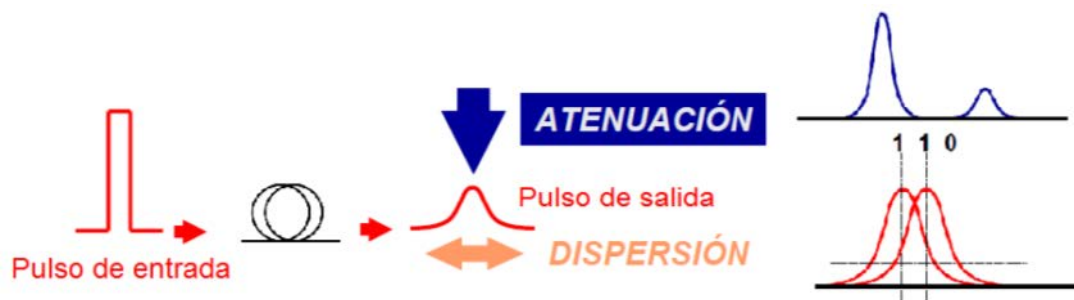
Fig. 7 Efectos de la transmisión en fibra óptica, atenuación y dispersión [GAR08].
