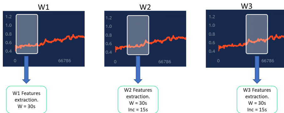
Figura 4.4: Proceso de segmentación en ventanas de 30s de duración e incremento de 15s.
