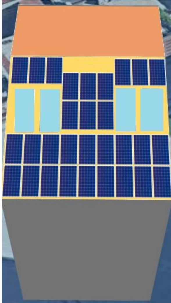
*Ilustración 16. Disposición de los paneles fotovoltaicos sobre la cubierta orientada hacia el sur [Elaboración propia con SolarEdge]*
