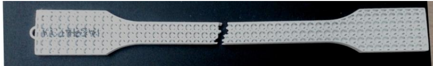
Ilustración 20. Rotura en la extracción de la pieza de la impresora.
