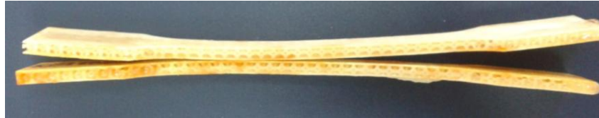
Ilustración 21. Combado durante el curado.
