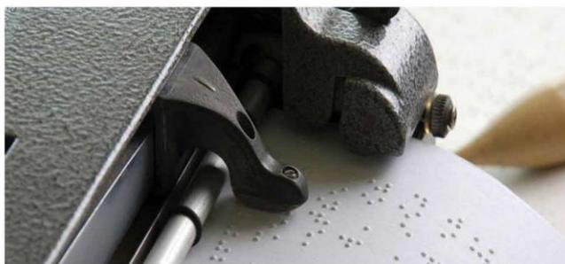
**Imagen 8: IMPRESORA BRAILLE.** Son máquinas que imprimen en puntos la información que les llega del ordenador.
