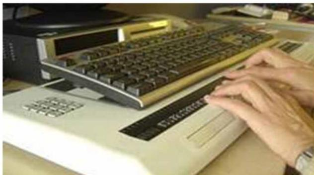
**Imagen 7: LINEA BRAILLE.** Equipo de sobremesa en el que se muestra una línea de celdillas integradas por vástagos móviles que simulan 8 puntos braille cada una.
