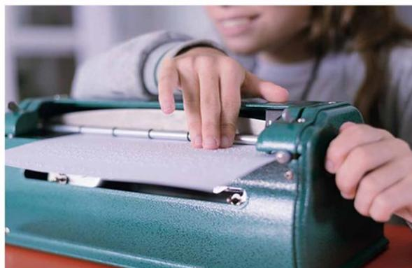
**Imagen 10: MÁQUINA PERKINS.** Máquina de escribir mecánica en sistema braille.
