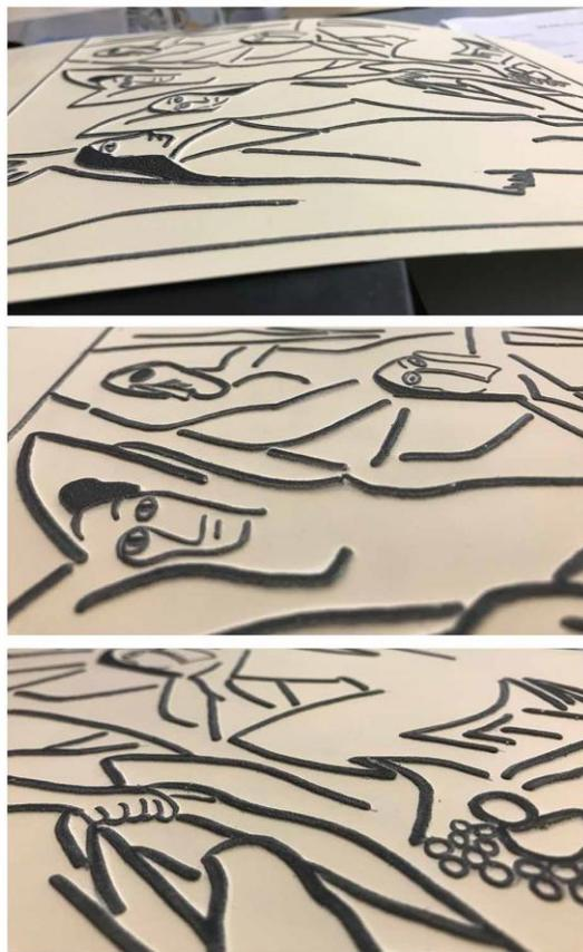
**Imagen 2:** conjunto de imágenes del resultado obtenido al introducir en el horno fuser una imagen de una obra dibujada con tinta sobre un papel especial.
