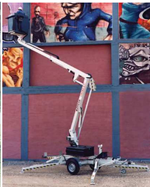
Figura 10. PEMP en fachada.
