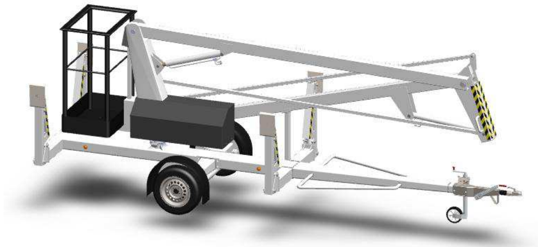
Figura 72. Imagen de la PEMP en posición de transporte.
