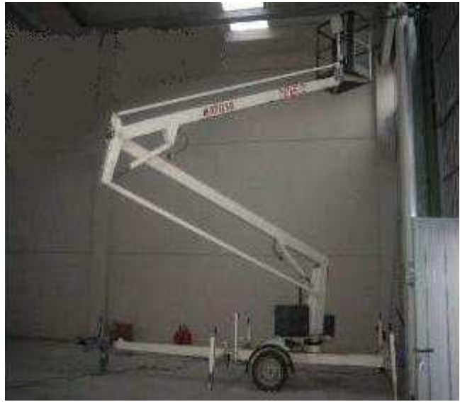
Figura 12. PEMP en nave industrial.
