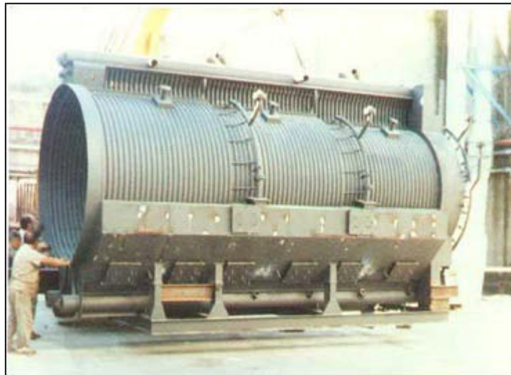
Figura 1: Cámara torsional sin su aislante externo (20 t/h de vapor saturado a 12 bar)
