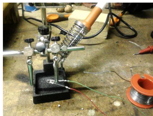
Fig. 53b. Diodo soldado con estaño.
