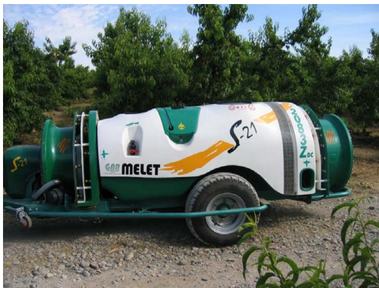
Fotografía 2. Pulverizador hidroneumático GARMELET con dos ventiladores axiales con giro invertido.
