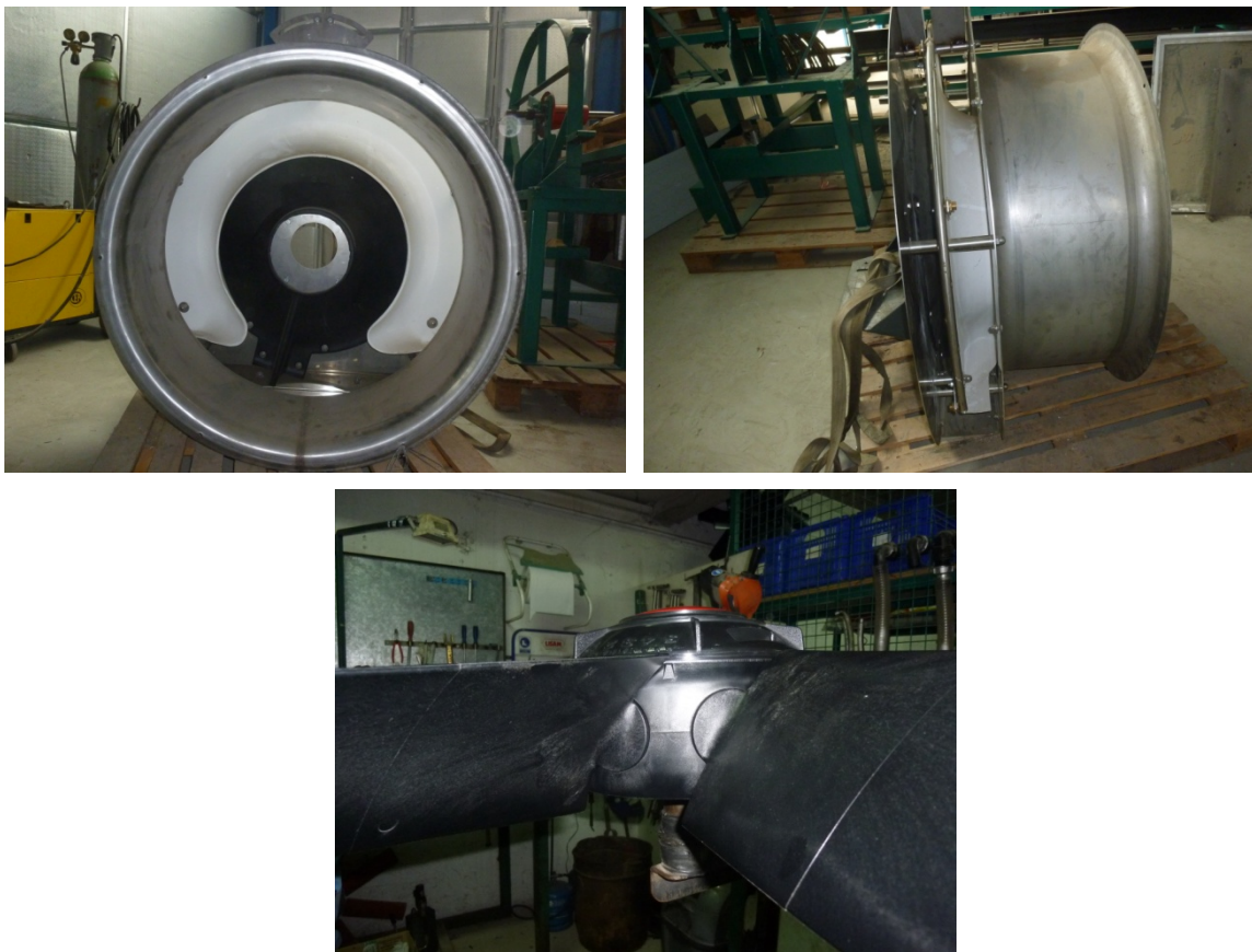
Fotografía 12. Arriba: Virola, vista frontal y lateral; Abajo: ángulo de calado de los álabes del ventilador
