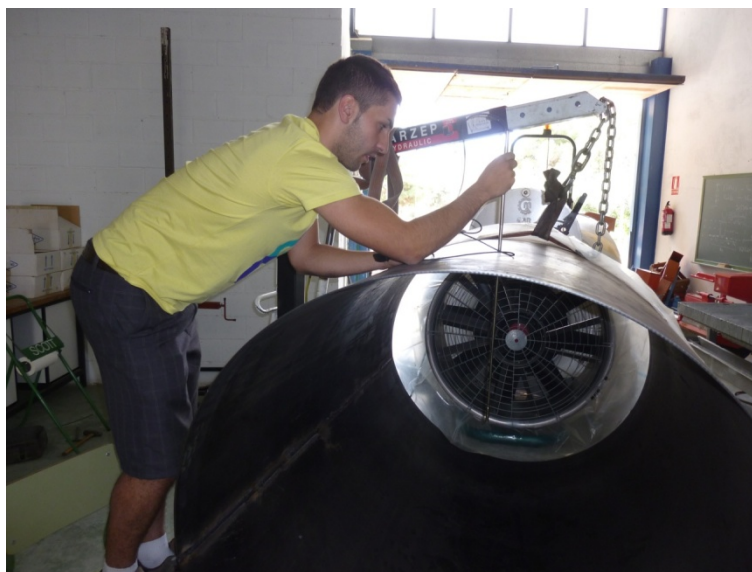
Fotografía 9. Medida de la velocidad del aire mediante el anemómetro de hilo caliente (Testo).
