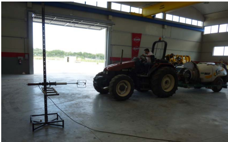
Fotografía 11. Toma de datos realizada con el anemómetro ultrasónico tridimensional WindMaster durante la pasada del tractor a una altura de 1 m.
