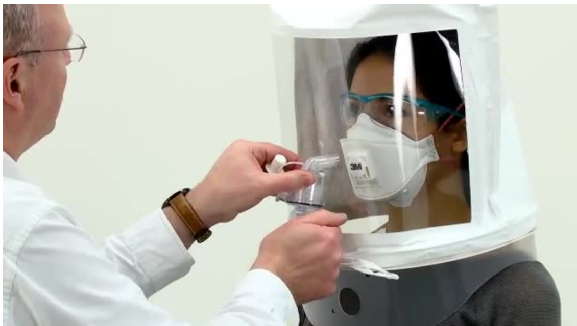
Imagen 6.7. Comprobación de ajuste de EPI respiratorio.
