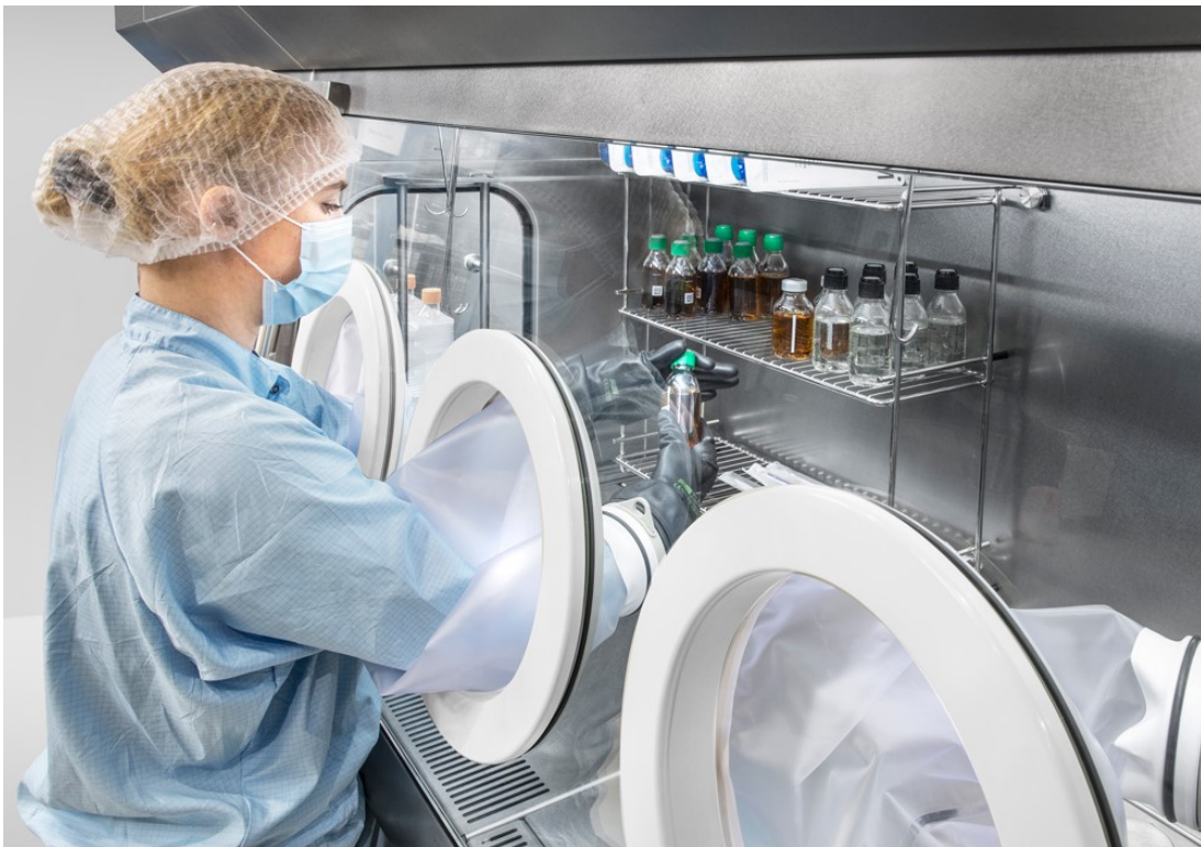
Imagen 2.11. Cabina de aislamiento de seguridad.
